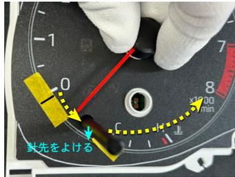
同様に軸の停止位置より更に針をねじりながら引抜きます。速度計の長針は、表示切替ボタンのバーをよけながら回します。
