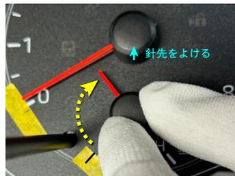
軸の停止位置より更に針を回しながら引抜きます。長針をよけながら回します。
