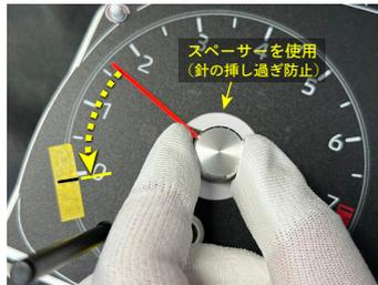
ゼロ位置より上で軸が停止する所に針を挿し、印をしたゼロ位置に針を回し合わせます。ずれた場合は再度挿し直して下さい。
