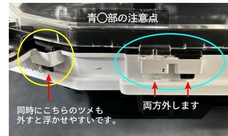
青○部 2カ所だけ、メーターの土台部にクリアカバーのツメが挿さっています。
